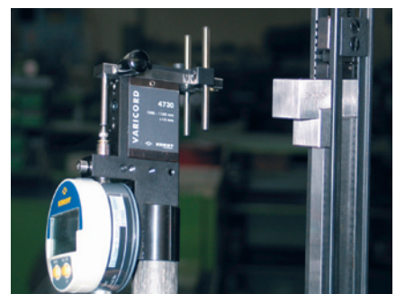
Bild 2. Einstellung von Varicord mit dem dazugehörigen Einstellstück (Foto: Kordt)
