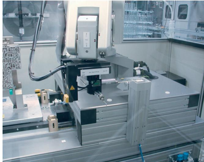
**Bild 2.** Der Messroboter wird automatisch kalibriert
