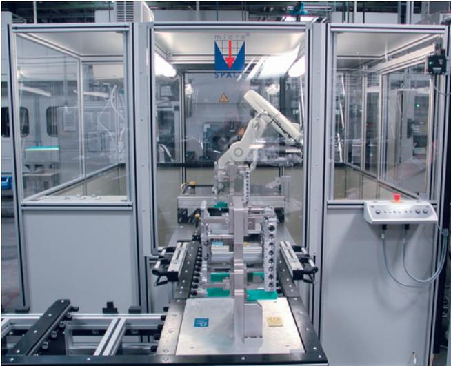
**Bild 1.** Eine klimatisierte Umhausung mit Shuttle-System schützt den Messroboter vor Kontaminationen
