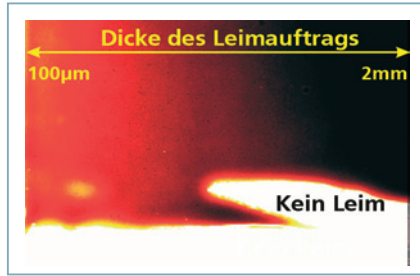
Bild 5. Schichtdicke des Leimauftrags auf einer Spanplatte. Dunkler Bereich: Leimauftrag 2 mm; hellroter Bereich: Leimauftrag 100 Mikrometer; weißer Bereich: kein Leimauftrag (Quelle: Fraunhofer WKI)
