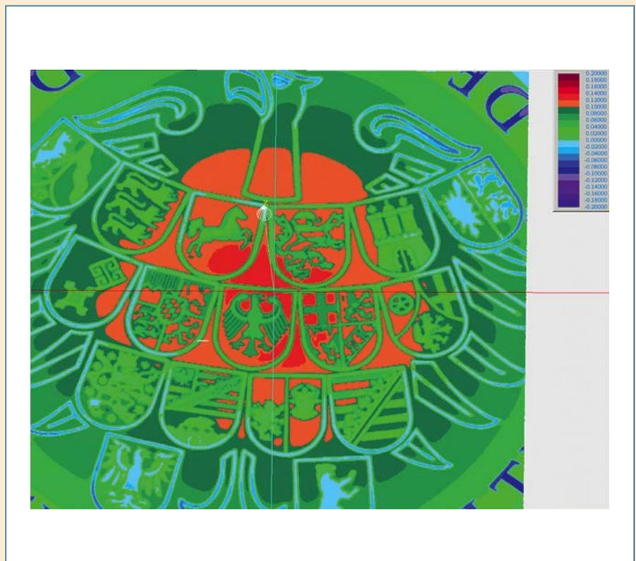
**Bild 1.** Ungeregeltes Vorgabescanning eines Prägewerkzeugs für Münzen mit einem optischen Abstandssensor (farbkodierte Abweichungen zu einer Ausgleichsebene, da das Modell verständlicherweise nicht vorlag)
