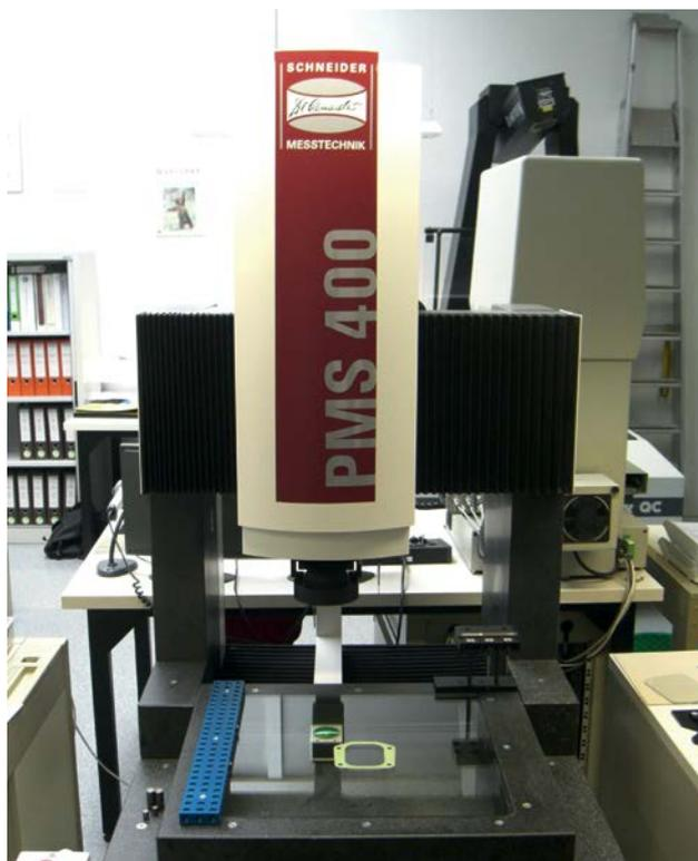
**Bild 1.** 3D-Multisensor-Portalmeßmaschine PMS für komplexe Messungen an Dichtungen
