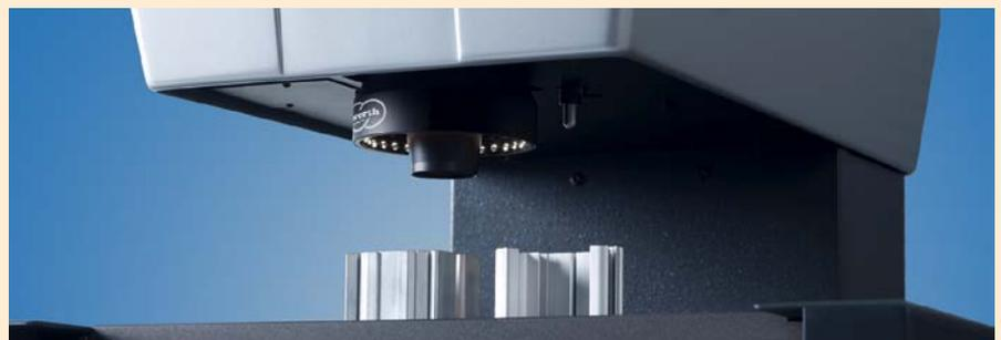
**Bild 1.** Mit diesem 2D-Messgerät werden auch große Werkstücke „im Bild“ gemessen.
