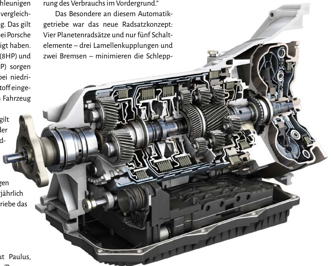
Bild 1. Das Automatikgetriebe basiert auf einem neuen Getriebekonzept mit vier Planetenradsätzen und fünf Schaltelementen. (© ZF/Werth)
