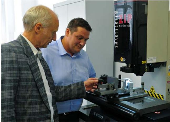
Bild 2. Dieter Schwenk (links) und Marcel Heß überprüfen am Videomesssystem den Messaufbau zur Bestimmung des Elastizitätsmoduls.
