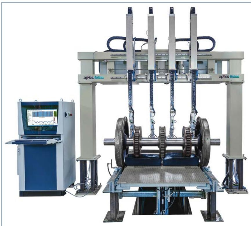
Bild 1. Ultraschallprüfsystem: Die gesamte äußere Oberfläche der Vollwelle wird abgetastet, ohne dass Räder, Bremscheiben und Lagerringe des Radsatzes demontiert werden müssen. (© Fraunhofer IKTS)
