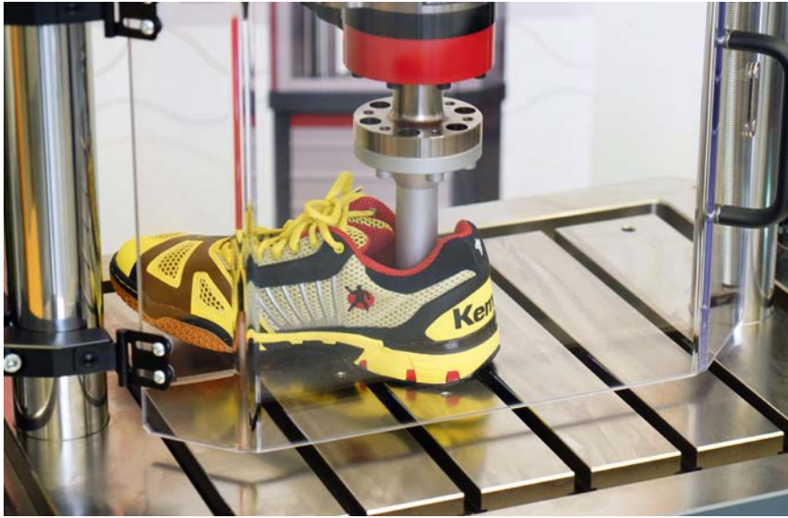
Bild 2. Handballschuhe: Messung des Winkelverlaufs im Vorfußbereich bei bestimmten Laufgeschwindigkeiten (© Zwick)
