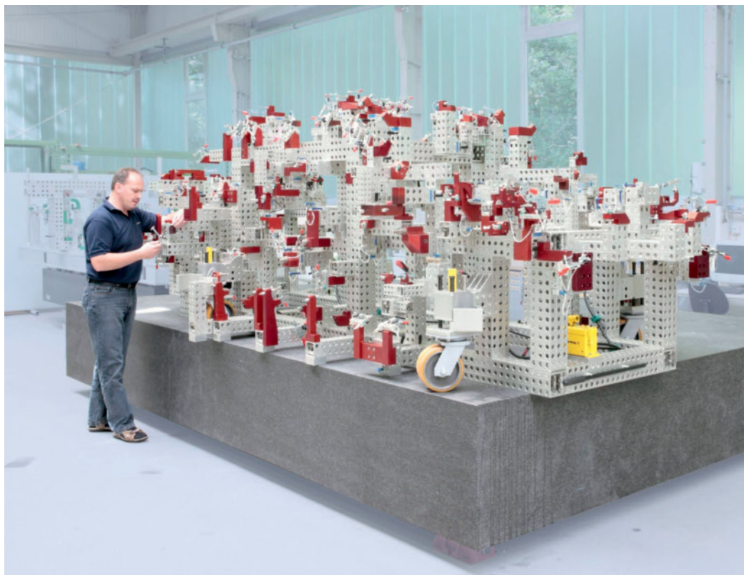
Bild 1. Mit Alufix Classic können Messaufnahmen, Kontrollvorrichtungen, Montage- und Schweißvorrichtungen, Lehren, Kuben, Innen- und Außenmeisterböcke erstellt werden.
