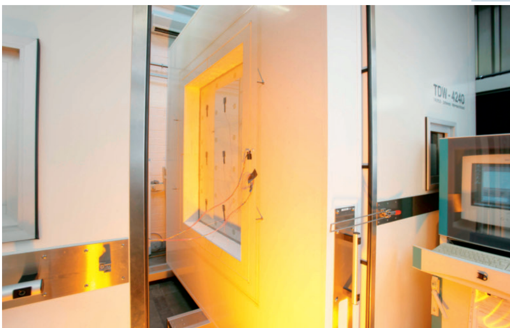
Bild 2. Prüfung des Wärmedurchgangswertes von Rahmenprofilen
