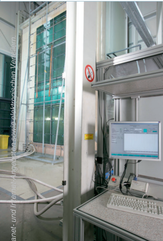
Bild 1. Dichtigkeits- und Erdbebenprüfungen an Großfassaden
