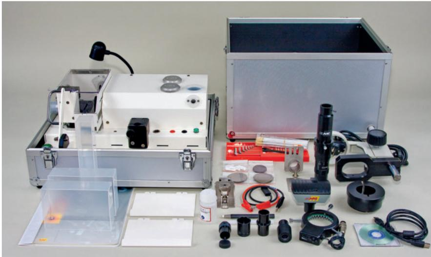
**Bild 1.** Mit dem mobilen Schlißbildlabor kann die Qualität von Crimpverbindungen im laufenden Betrieb überprüft werden.
