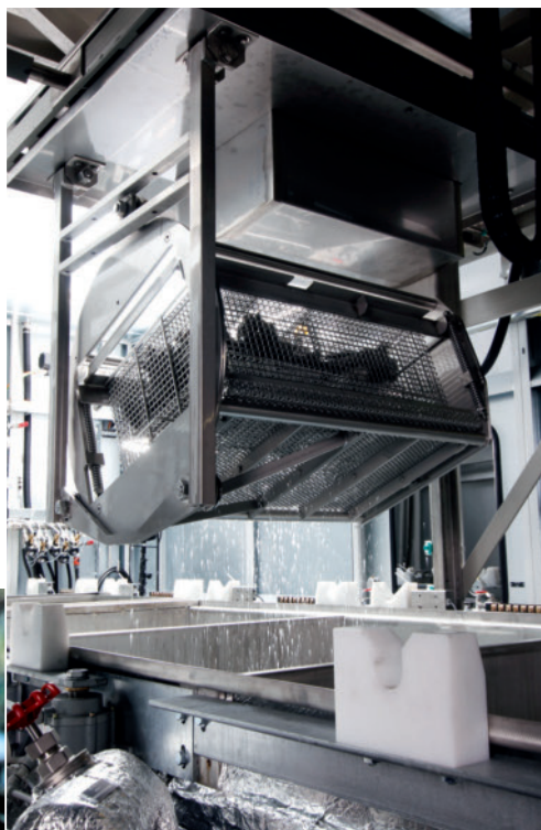
Bild 2. Viele Parameter bestimmen den erfolgreichen Reinigungsprozess. So haben unter anderem das Bauteildesign und die richtige Lagerung des Bauteils im Korb des Spülkabinetts Einfluss darauf, ob die Spülflüssigkeiten überhaupt durch das Bauteil fließen können.
