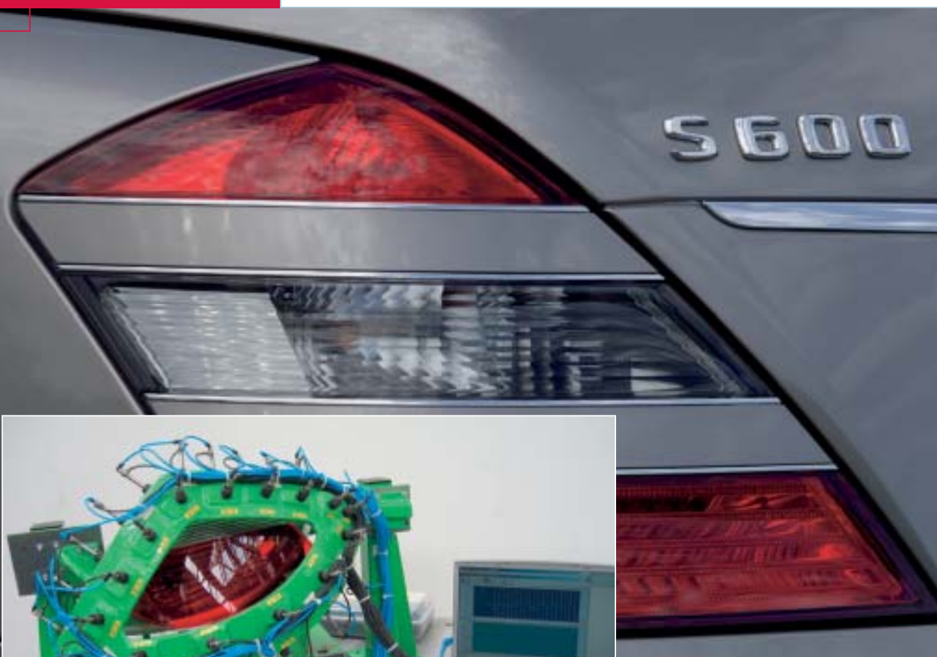
Bild 1. Die 32 Messtaster pro Heckleuchte sind in einer Messbrille integriert und legen sich pneumatisch an das Bauteil an
