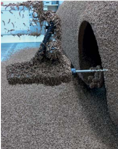
Bild 2. Fräsen einer kompletten Fahrzeugseite eines 1:1-Clay-Modells
