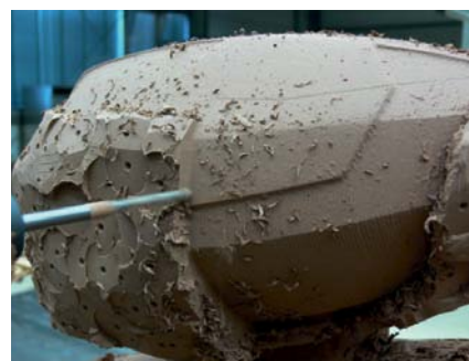
Bild 1. Die Fahrerkabine eines Pistenbullys wird in Clay gefräst.
