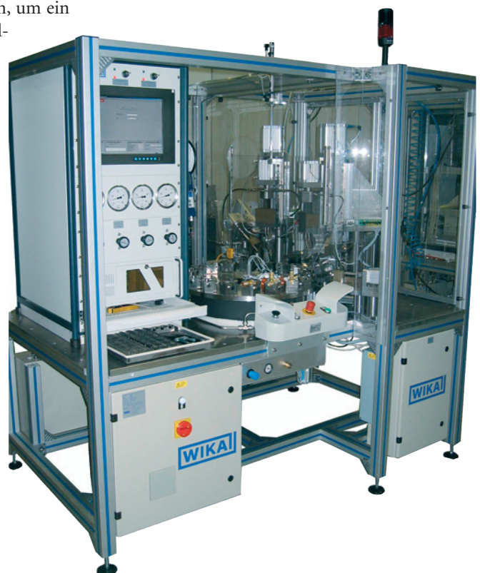
Bild 3. Mit automatisierten Einstell- und Prüfprozessen an druckbeaufschlagten Bauteilen lassen sich die Fertigungszeiten verkürzen
