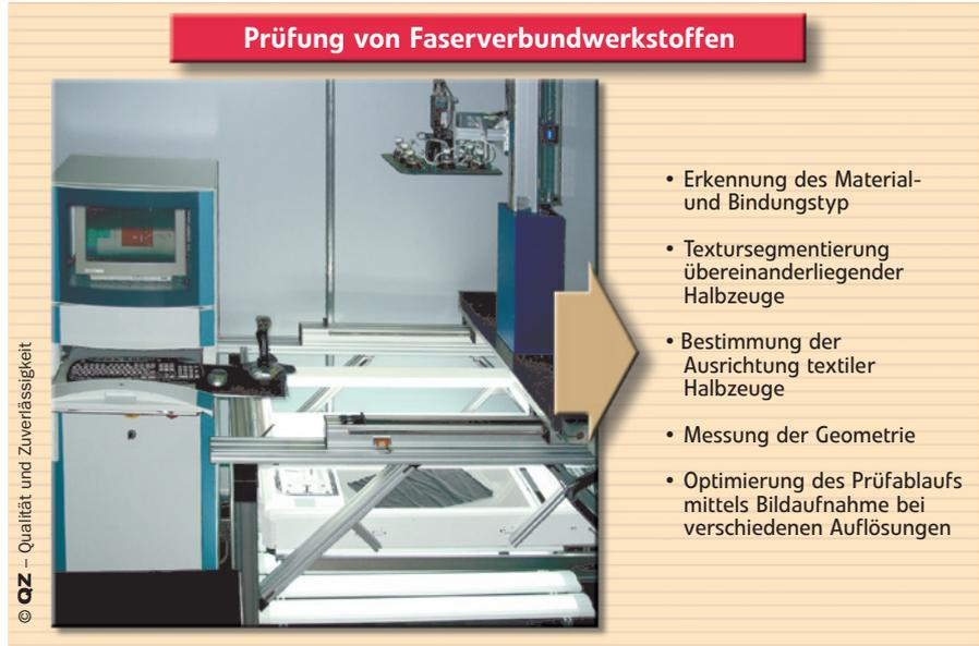
**Bild 2.** Die Aufnahmekette eines Bildverarbeitungssystems zur Prüfung von Faserverbundwerkstoffen wurde analysiert und die Störgrößen bestimmt
