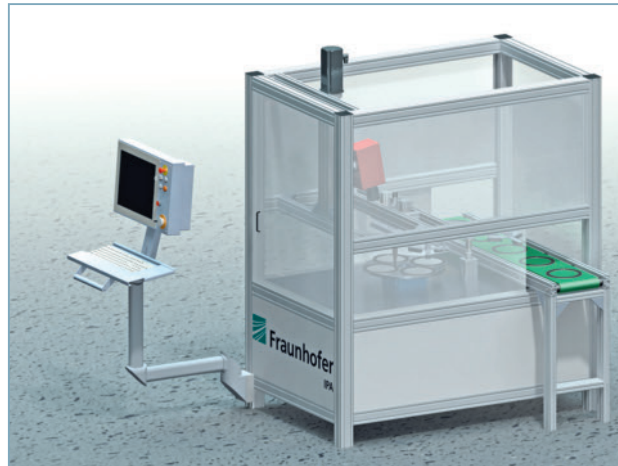
Bild 3. Konzept einer Prüfstation zur prozess-integrierten Qualitätsprüfung von Kupplungsscheiben
