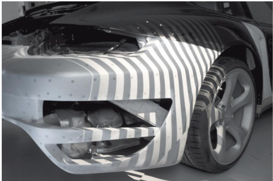
Bild 2. Modellierter Halbschürze mit aufprojiziertem Streifenmuster für das 3D-Scanning
