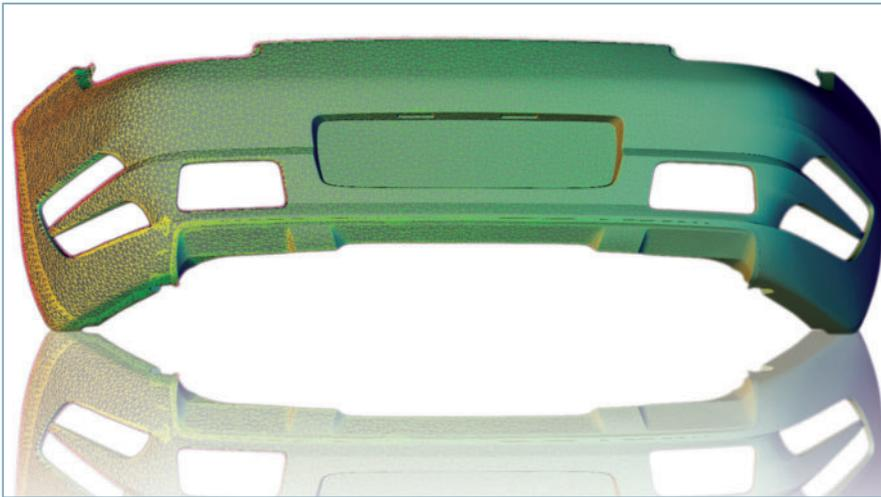
**Bild 3.** 3D-Modell der Heckschürze mit künstlerischer Darstellung der beim 3D-Scanning erzeugten Dreiecksnetze, aus denen die Geometrie des Objekts im Computer zusammengesetzt ist
