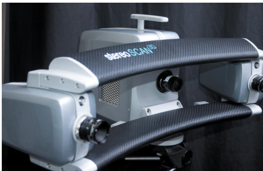
**Bild 1.** In der Mitte des High-Definition-3D-Scanners befindet sich der Streifenprojektor, außen die beiden Kameras. Alle Teile sind über eine form- und temperaturstabile CFK-Struktur verbunden
