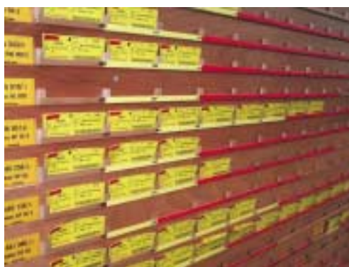
Bild 1. Dynamische Produktionsplanung durch Steckkarten: Jede Karte enthält die zur Fertigung benötigten Produktinformationen wie Type, Montageinsel und Losgröße (Artikel pro Palette). Farbige Markierungen zeigen auf einen Blick, was als nächstes hergestellt werden muss
