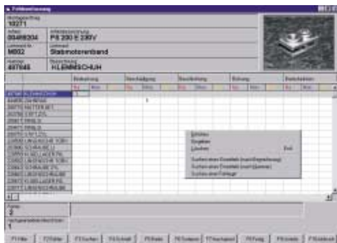
Bild 3. In einer dynamischen Fehlersammelmaske werden an unterschiedlichen Prüfstellen erfasste Fehler (mit jeweils unterschiedlichen Fehlerorten und -arten) zusammengestellt und können so zügig und effizient bearbeitet werden
