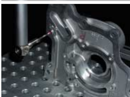
Bild 4. Kalibrierung eines Pumpengehäuses
