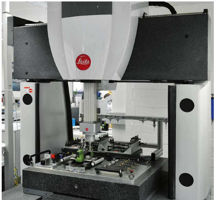
Bild 1. Ein Tastkopf mit integriertem High-Speed-Scanning erfasst große Punktmengen und ist damit auch zur schnellen Formmessung geeignet. (© STIHL)
