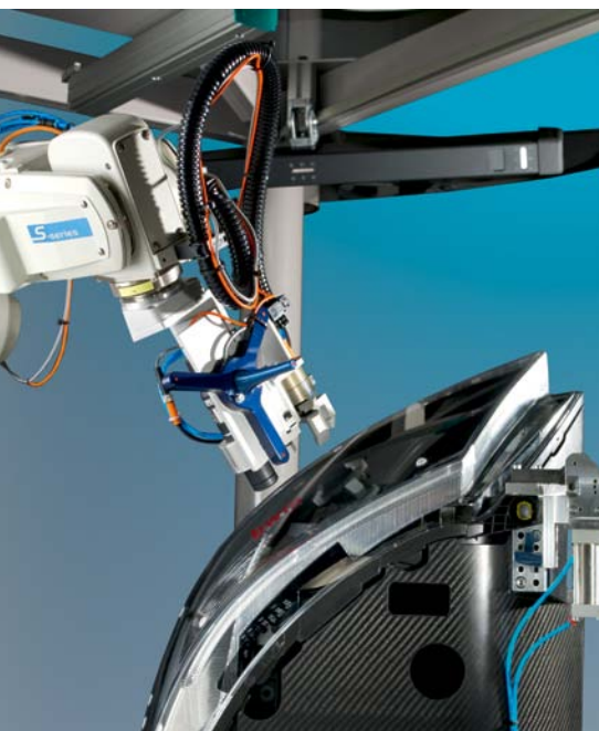
Bild 1. 3D-Formmessung von Scheinwerfern: Das Roboter messsystem erreicht Wiederholgenauigkeiten von bis zu 20 Mikrometern.
