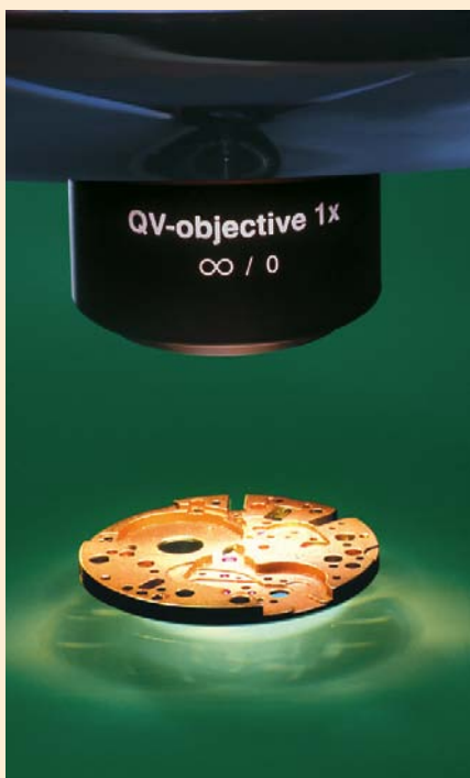
Bild 1. Beim Durchlicht führt diffuses Licht dazu, dass die Kante im Bild unscharf erscheint.
