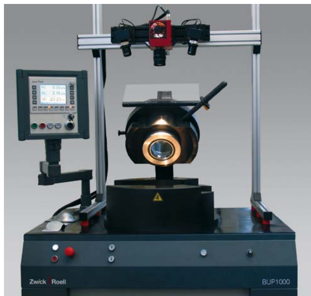
Bild 4. Blechumformprüfmaschine mit installiertem 3D-Verformungsanalysensystem (Foto: Zwick)
