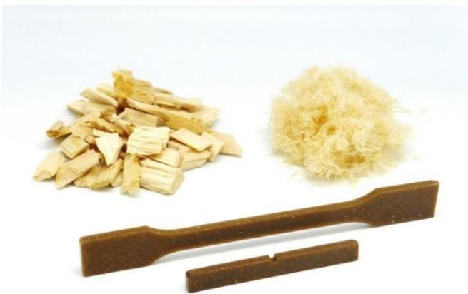
*Bild 1: Hackschnitzel und Fasern aus Fichte (Hintergrund), Zugprüfstab und Kerbschlagbiegeprüfstab aus Polypropylen mit 20 Gew.-% Fichte (Vordergrund) über Spritzgusscompounder direkt compoundiert*
