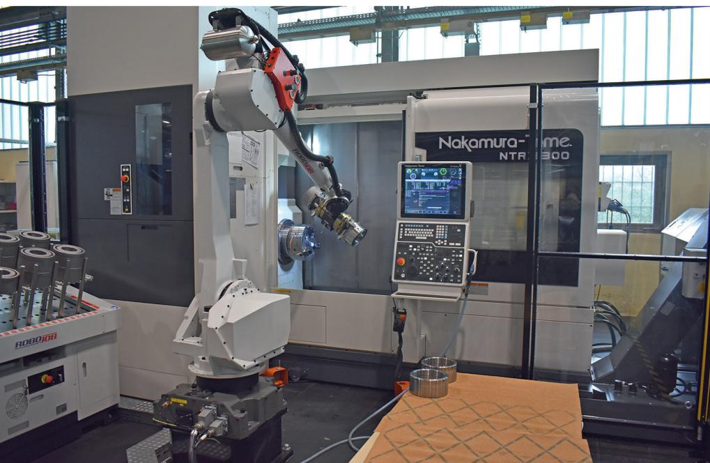
1 Vollautomatisiertes Fertigungssystem für die Komplettbearbeitung: Drehfräsmaschine Nakamura-Tome NTRX-300 mit 6-Achs-Knickarmroboter von RoboJob © Hommel
