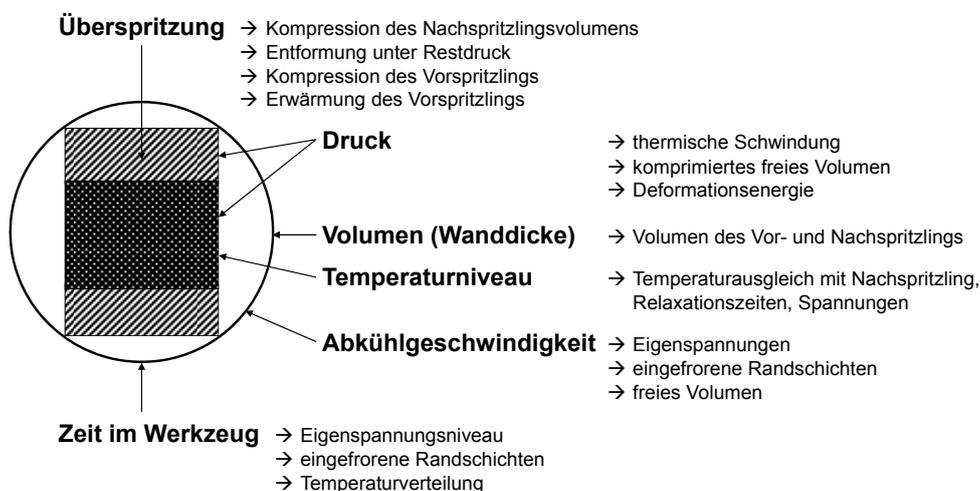
Bild 6.4 Effekte bei der Herstellung der Mehrschichtprüfkörper
