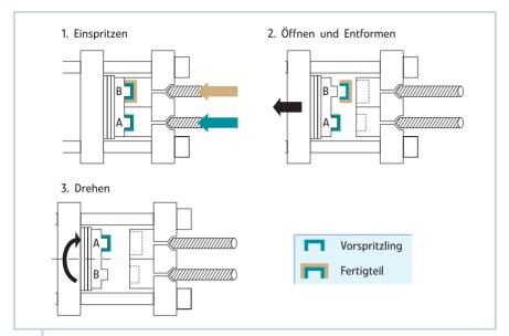
Drehtellertechnik: Sowohl die hier abgebildete Drehtellertechnik als auch die Etagenwendetechnik erlaubt die Herstellung mehrkomponentiger, komplexer Formteile auf einem hohen Produktivitätsniveau. Die verschiedenen Stationen liegen beim Drehteller auf einer Formplatte, so dass die Flächenausnutzung geringer ist als bei der Etagenwendetechnik.
