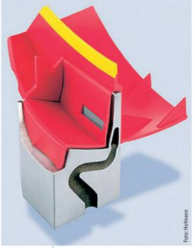
Cool bleiben: Bei der konturangepassten Temperierung können durch spezielle Fertigungsverfahren die Kühlkanäle nahezu beliebig komplex angeordnet und damit konturnah in die Form eingebracht werden.
