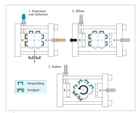
Etagenwendetechnik: Bei diesem Verfahren wird eine symmetrische Krafteinleitung gewährleistet. Während beim Drehteller die Drehachse in der Horizontalen liegt, dreht sich ein Etagenwendewerkzeug um eine vertikale Achse. Im Vergleich zu Drehwerkzeugen ist außerdem nur die halbe Schließkraft notwendig.
