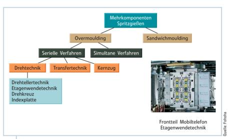
**Mehrkomponententechnik:** Zur Herstellung mehrkomponentiger Kunststoffformteile bieten sich verschiedene Spritzgießverfahren an, die sich nach der Art der Komponentenzusammensetzung einteilen lassen. Dabei spielen die drehenden Werkzeugkonzepte eine wichtige Rolle.
