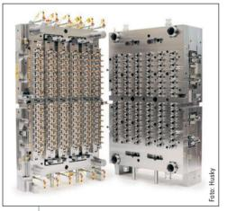
High End: Eine Anwendung der Mehrkavitäten-Werkzeugtechnik sind PET-Vorformlingsysteme – beispielsweise dieses 96fach-Zweiplattenwerkzeug. Solche Systeme zeichnen sich durch eine enorme Produktivität aus, bei der bis an die Grenze der Leistungsfähigkeit der Plastifizieraggregate gegangen wird.
