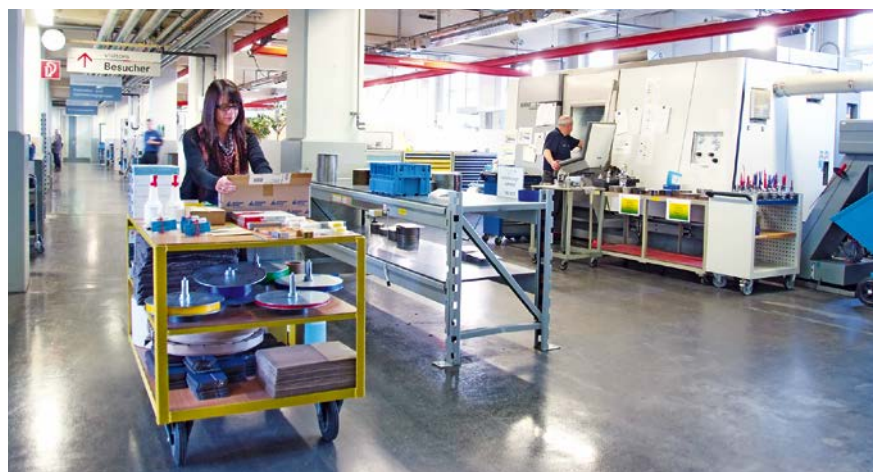
Taktfertigung: Die Werkzeuge werden in einem Taktwagen von Station zu Station transportiert. (Bild: ZF)
