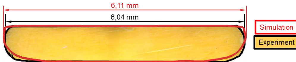
Bild 14: Vergleich der realen (gelb mit schwarzem Rand) mit der rechnergestützt ermittelten Stranggeometrie (rote Kontur)
