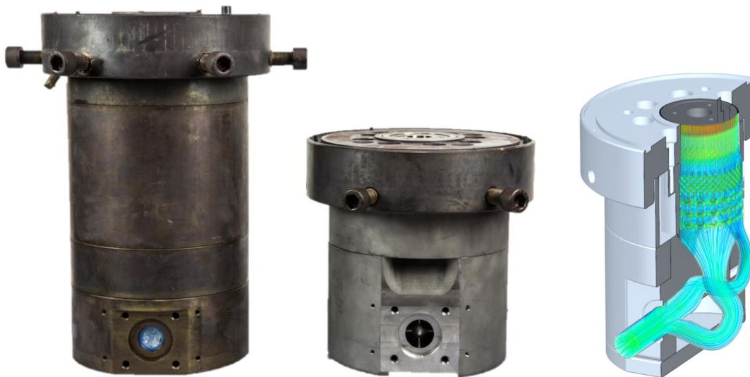
Bild 14: Gegenüberstellung eines konventionell gefertigten Blasfolienwerkzeuges (l.), des additiv gefertigten Demonstratorwerkzeuges (m.) und der Strömungssituation innerhalb des Werkzeugs (r.)
