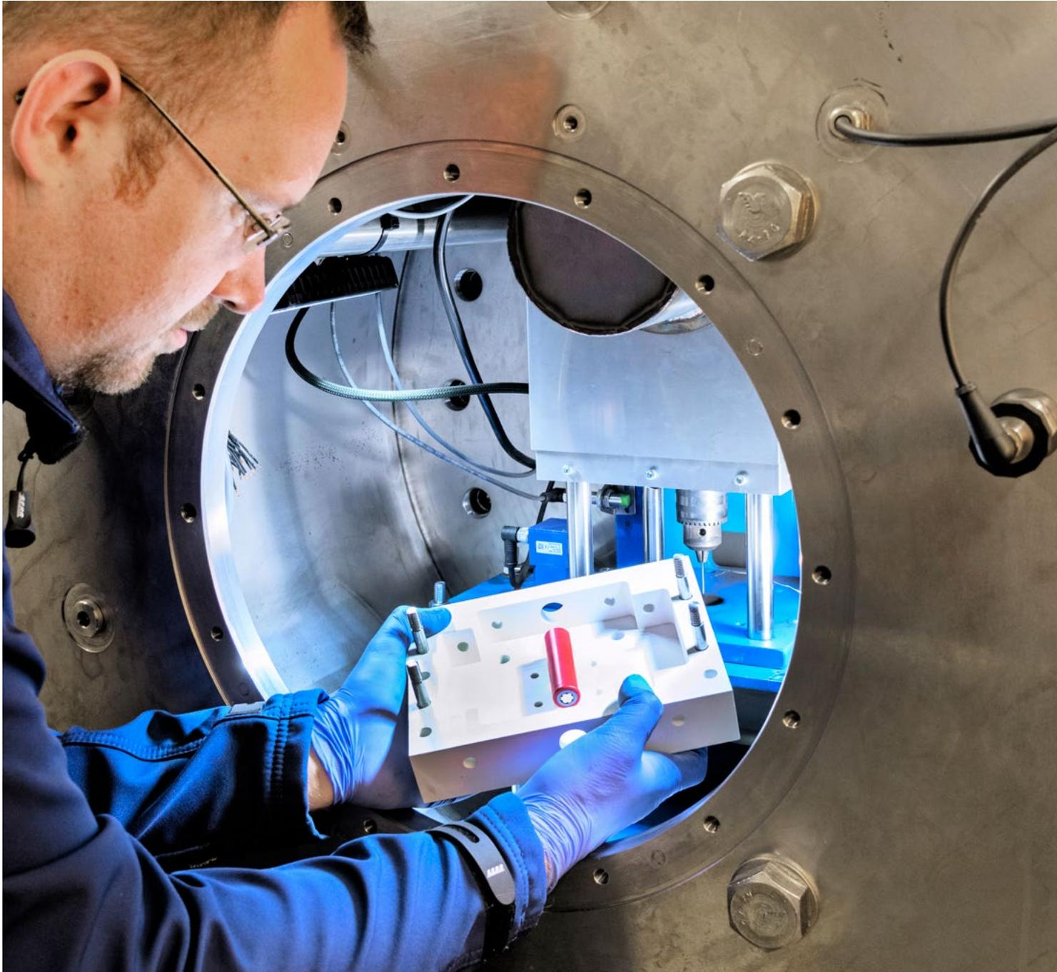
Untersuchungen zur mechanischen Belastung einer Batterie.
