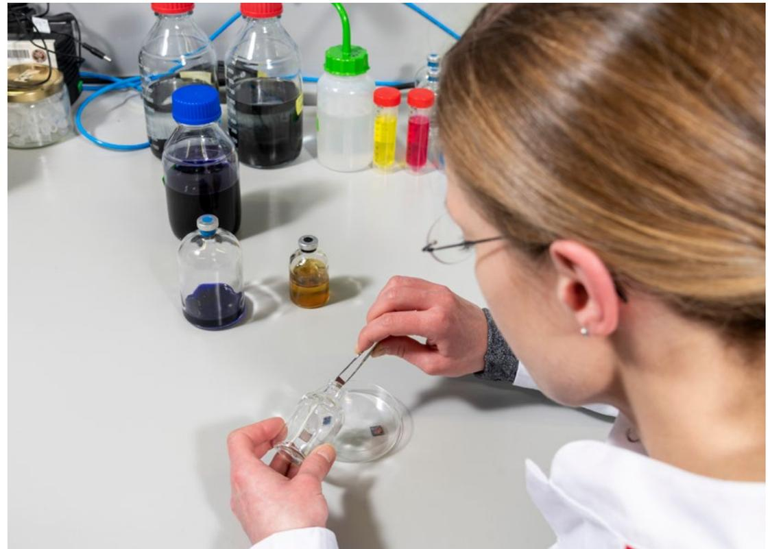
Andrea Koerdt setzt Metallproben gezielt einem Medium mit Mikroben aus, um die Mechanismen der Einzeller zu entschlüsseln.
