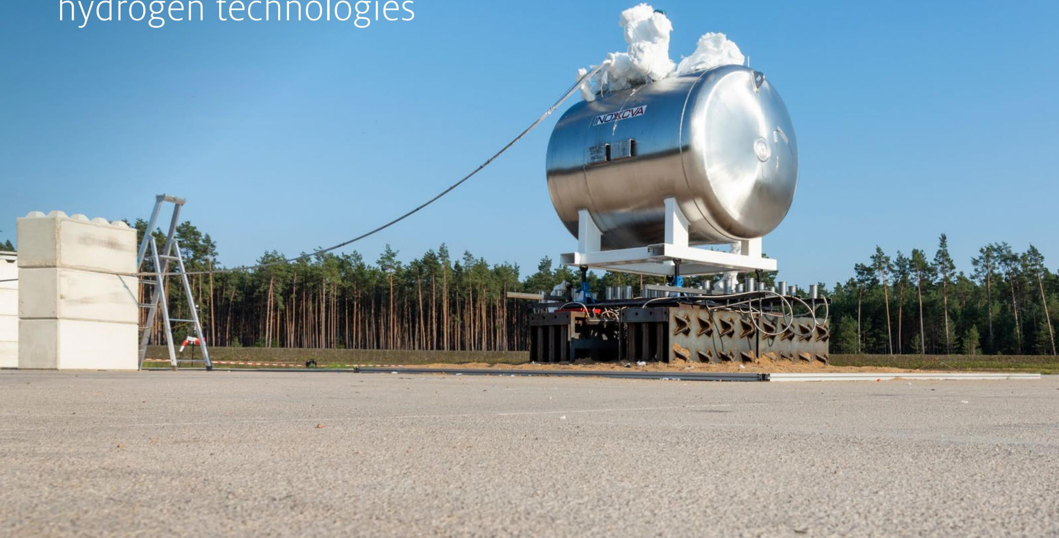
Versuch zur Brandsicherheit eines Tanks mit 25 Kilogramm Flüssigwasserstoff auf dem Testgelände der BAM.
