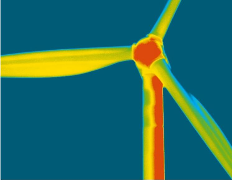
Bei der Messung werden alle drei Rotorblätter einer Anlage erfasst. Temperaturdifferenzen weisen auf strukturelle Schäden hin.
