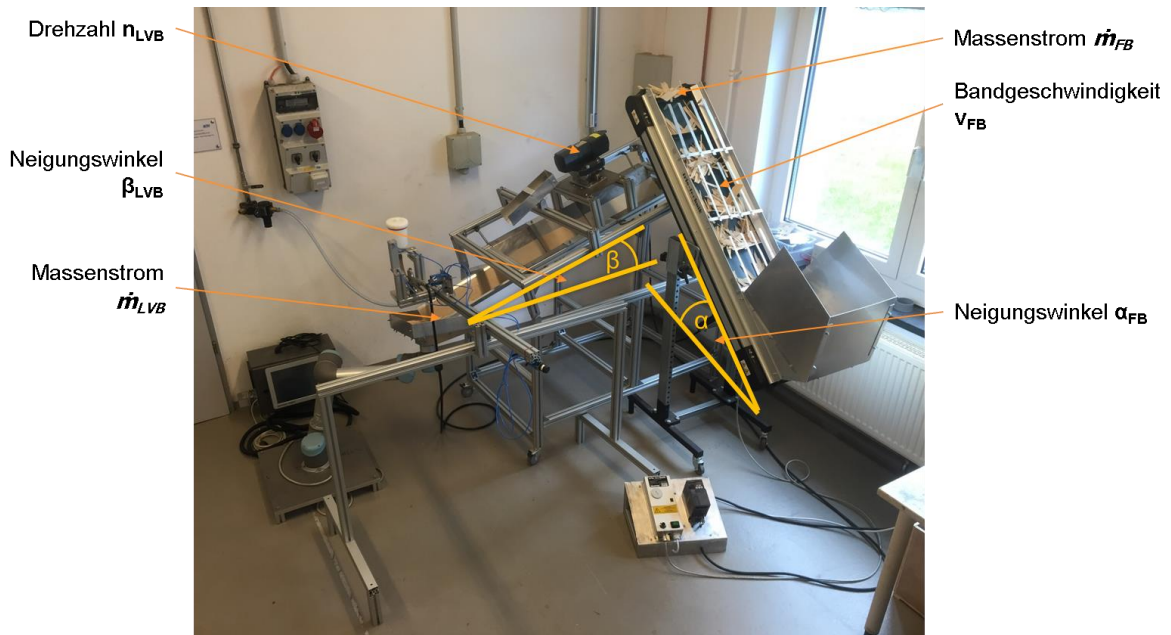
Bild 5: Labormaßstäblicher Prototyp eines Systems zur Dosierung, Längsausrichtung und Vorformung der Strands im HKV Prozess
