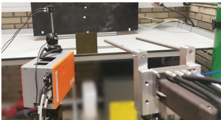
*Bild 4: Darstellung des experimentellen Versuchsaufbaus: Thermografiekamera (links unten), Photodiode (links oben), VCSEL Array (rechts), CFK-Prüfkörper (Mitte)*
