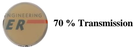
Abbildung 9-1: 80:20 Blend aus PC-41 (OH) mit PMMA-60 (GMA4) .
