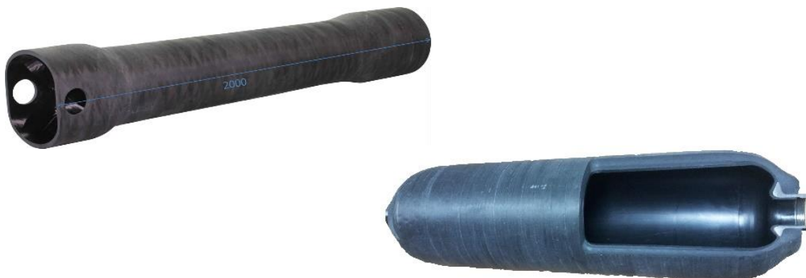
Bild 1.1: Ausgewählte Beispiele für dickwandige FKV-Bauteile am ILK, Schwerlastgelenkwelle mit Wanddicken bis 20 mm (links) und Hydraulikblasenspeicher mit Wanddicken bis 30 mm (rechts)
