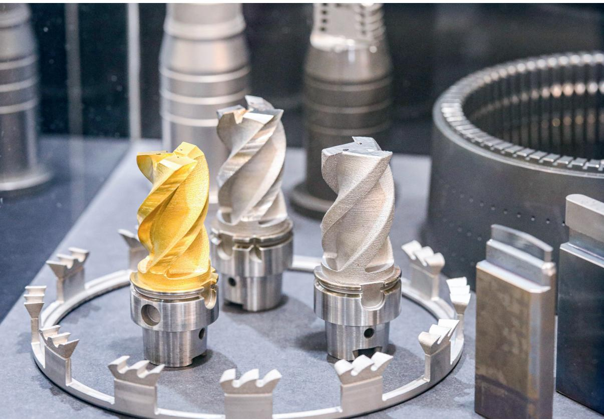
**Gedruckte Standzeitwunder:** Sonderwerkzeuge, Schneidstempel und Matrizen sowie Formkerne aus eigener Herstellung
