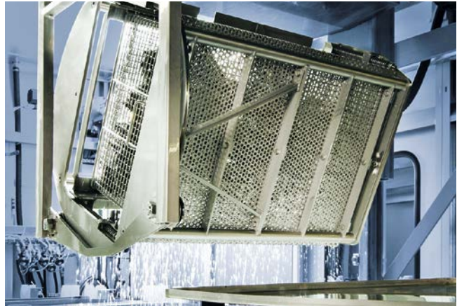
3 Entsprechend lange Abtropfzeiten tragen – insbesondere bei der Reinigung von Schüttgut – dazu bei, die Verschleppung von Medien in nachfolgende Bäder zu minimieren (Bild: Dürr Ecoclean)
