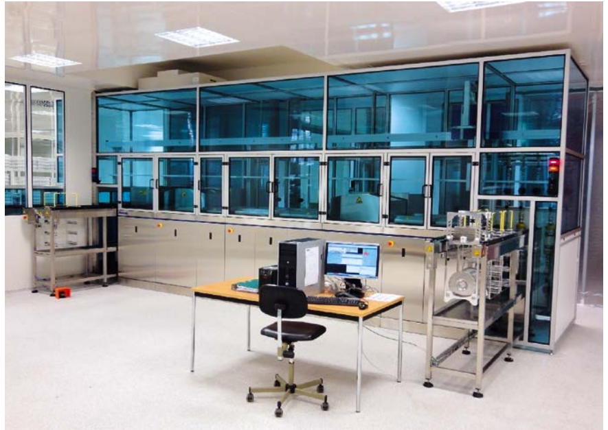
4 Reihentauchanlagen ermöglichen es, unterschiedliche Behandlungsstufen wie Reinigen, beispielsweise ohne und mit Ultraschall, Spülen, Passivieren und Trocknen beliebig zu kombinieren (Bild: Amsonic)
