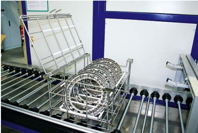
2 Der Einsatz wässriger Reiniger für Aluminiumteile macht Materialverträglichkeitstests und eine Anpassung des Reinigungssystems erforderlich (Bild: Metallform Wächter)
