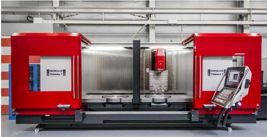
Die T7 3200 ist mit zwei Schwerlast-NC-Rundtischen für den Pendelbetrieb in der Serienfertigung ausgelegt. Die stufenlos schwenkbare Hauptspindel und die Rundtische bieten 5-Achs-Bearbeitung auf zweimal 1330 × 750 × 695 mm (Bild: Hedelius)
