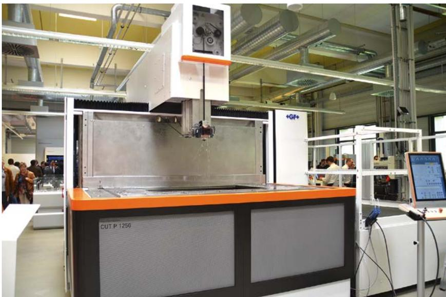
**3 Blickfang:** Die neue AgieCharmilles CUT P 1250 wurde auf Anregung von Kunden entwickelt. Mit der Fähigkeit, bis zu 2300 mm x 1300 mm x 800 mm große Werkstücke zu bearbeiten, ist sie eine der größten Drahterodiermaschinen überhaupt (© Hanser)
