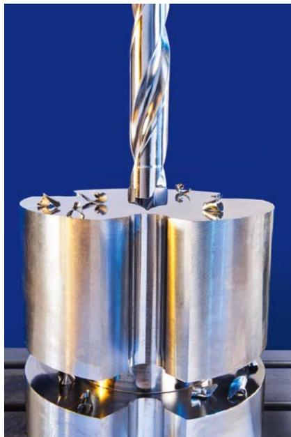
**1** Dieser Wechselkopfbohrer ist mit einem selbstzentrierenden Bohrkopf ausgestattet, der es aufgrund seiner sehr guten Zentrierfähigkeit ermöglicht, Bohrungen bis  $12 \times D$  ohne Pilotbohrung in das Werkstück einzubringen (© Iscar)
