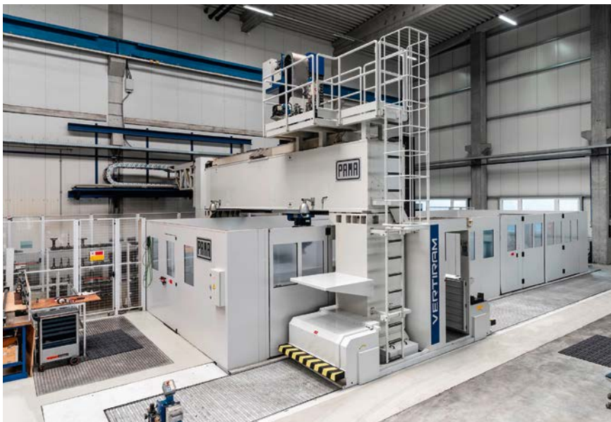
1 Dreh- und Fräsmaschine Vertiram 200 GT mit einem verfahrbaren Portal für die Vertikalbearbeitung sowie begehbaren X-Achsen (© Peter Springfeld)
