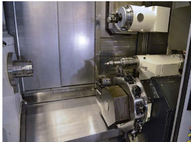
3 Der untere Revolver des Drehfräszentrums Multus U3000 ermöglicht einen vollautomatischen Werkzeugwechsel (© Okuma)
