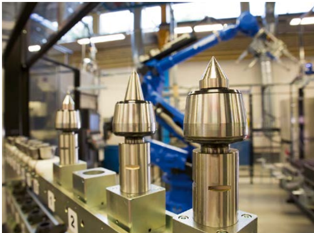
2 Ein externes Magazin hält die Reitstockspitzen, Spannzangen und Werkzeuge für den Austausch bereit und versorgt die Multus U3000 mit 40 verschiedenen Werkzeugen (© Okuma)
