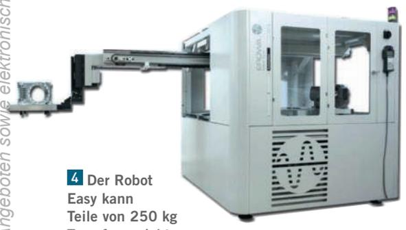
**4** Der Robot Easy kann Teile von 250 kg Transfergewicht auf eine Strecke von 1500 mm ausfahren
