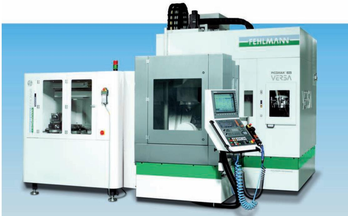
1 Automatisierte Fertigungslösung: das 5-Achs-BAZ Picomax 825 Versa einschließlich Handlinggerät Robot Easy
