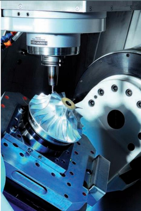
**2** Die Picomax 825 Versa ist für die Bearbeitung komplexer Teile ausgelegt, wie das Fräsen eines Impellers zeigt
