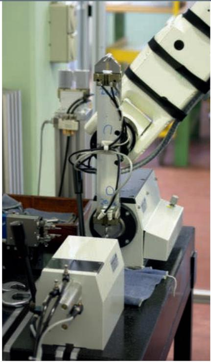
3 Mittels Post-Process-Messung wird die Einhaltung der Qualitätskriterien belegt. R<sub>a</sub>-Werte von 0,4 und Genauigkeiten von zwei Mikrometern sind dabei Standard
