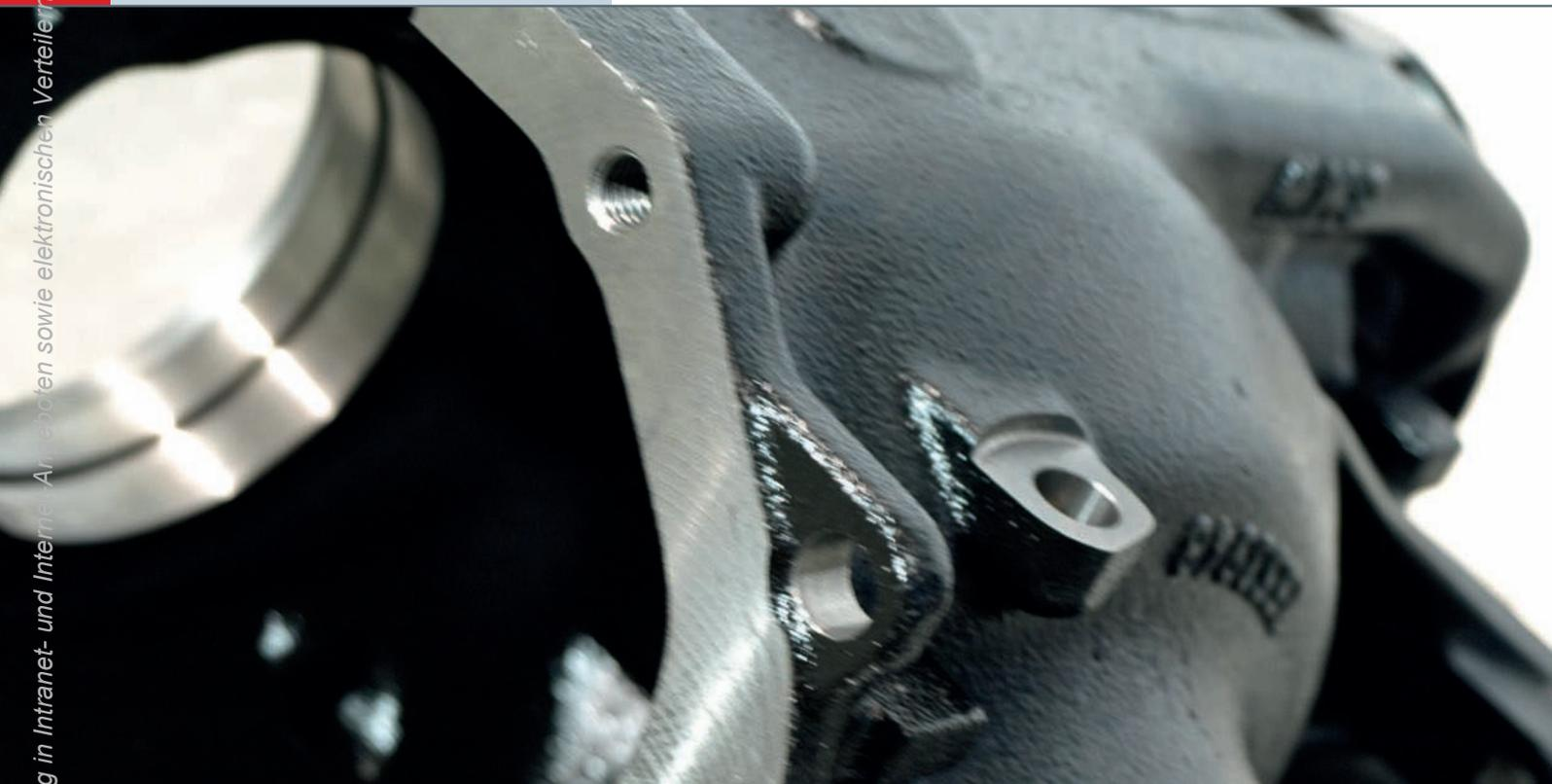
1 Indexbohrungen in Hinterachsgetriebe-Gehäusen sorgen bei Folgebearbeitungen und in der Montage für die Einhaltung enger Toleranzen
