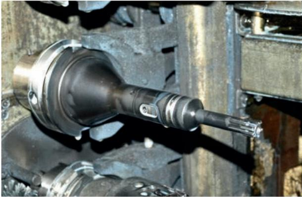
**2** Das Reibwerkzeug ›Reamax TS‹ von Dihart zeichnet sich durch kurze Rüstzeiten aus. Da Einstell- oder Justierarbeiten gar vollständig entfallen, lassen sich mit dem Werkzeug hohe Wiederholgenauigkeiten erreichen
