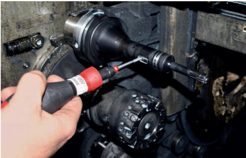
**3** Das einfache Austauschen der Reibköpfe in der Maschine erlaubt ein flexibles, anwendungsspezifisches Arbeiten mit verschiedenen Schneidgeometrien, Schneidstoffen und Beschichtungen
