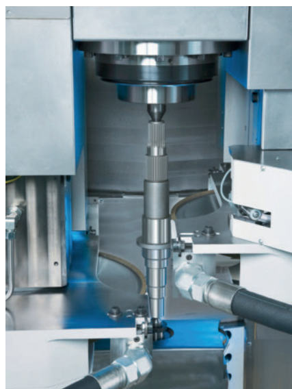
6 Gegenüber dem klassischen Verfahren wird mit zwei gegenüberliegenden Schleifspindeln 4-achsig simultan gearbeitet, wobei das Werkstück senkrecht gespannt ist
