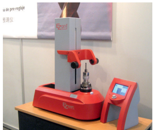
12 Werkzeugvoreinstellgerät »EZgo«: einfach zu bedienen, starke Bildverarbeitung, alle wichtigen Messfunktionen, konkurrenzfähiger Preis
