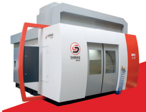
5 Vierspindliges horizontales BAZ ›MFZ 6-4W‹: Das hochproduktive Zentrum für die Bearbeitung großvolumiger Bauteile aus Stahl, Guss oder Aluminium gibt es auch mit drei oder zwei Spindeln
