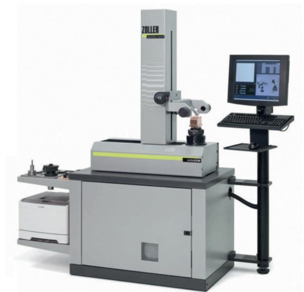
11 Voreinstellgerät »smile EDM«: erste Wahl, wenn der Anwender nicht nur Werkzeuge, sondern auch Elektroden vor dem Einsatz auf Erodiermaschinen einstellen und prüfen will
