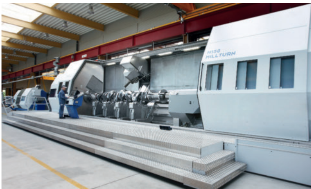
1 Die Königsklasse der Millturns, die ›M150 Millturn / 8000 mm‹: Sechs NC-Achsen (B, C, X, Y, Z, U), Pick-up-Magazin und schwere Innenbearbeitungswerkzeuge sind charakteristisch
