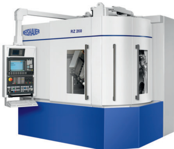
7 Wälzschleifmaschine ›RZ 260‹: Hartfeinbearbeitung von Zahnflanken von Zahnrädern mit einem Außendurchmesser bis 260 mm und einem Modul bis 4 mm
